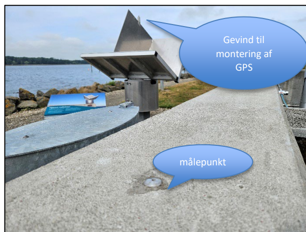
Figur 16 Reflektor til brug for montering af GPS samt målepunkt.
